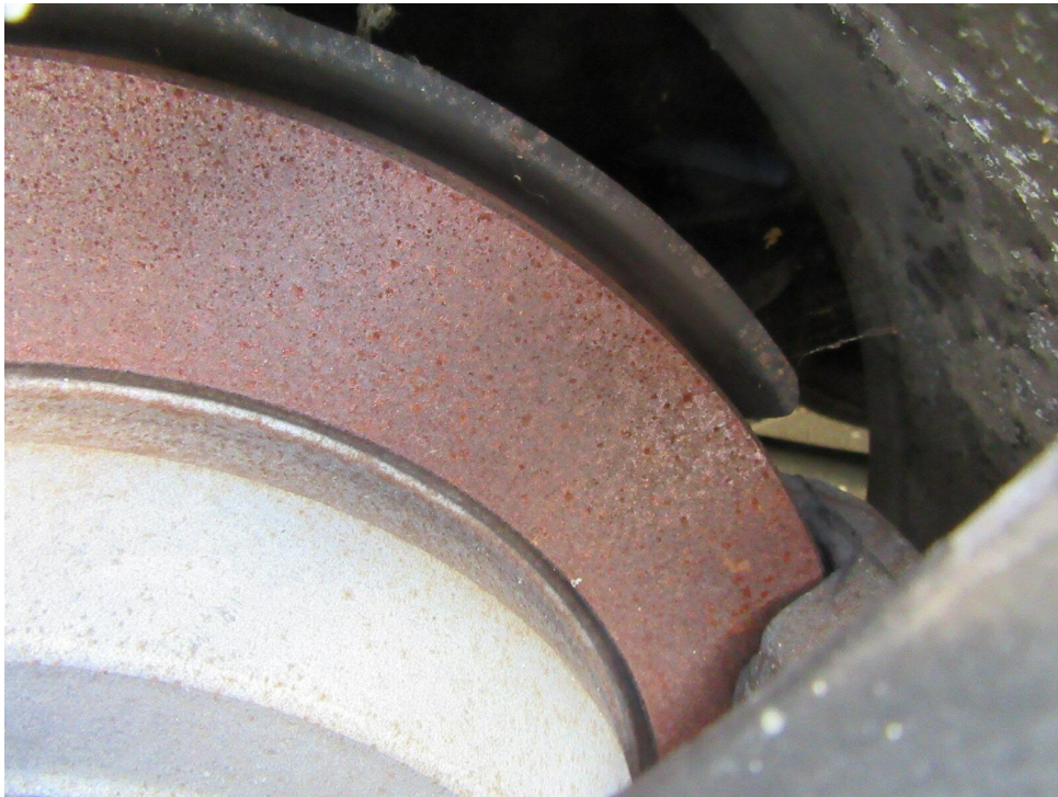
Bild 21 : Bremscheibe hinten rechts korrodiert
