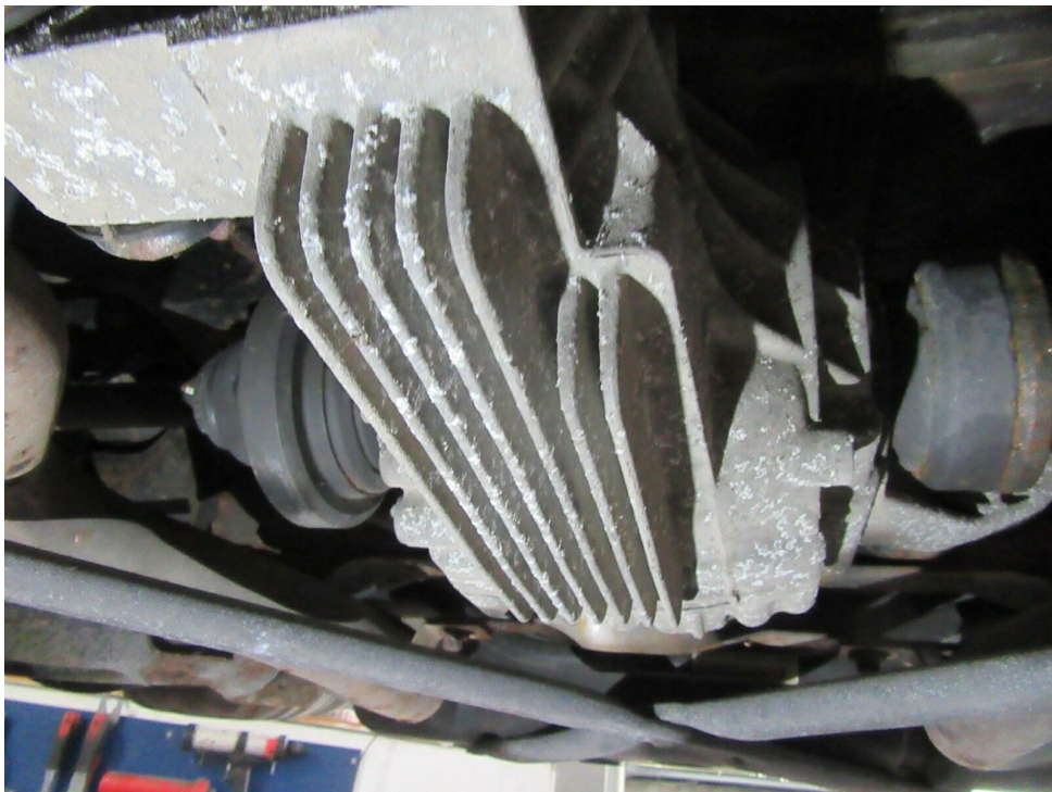
Bild 24 : Differenzialgehäuse stark korrodiert
