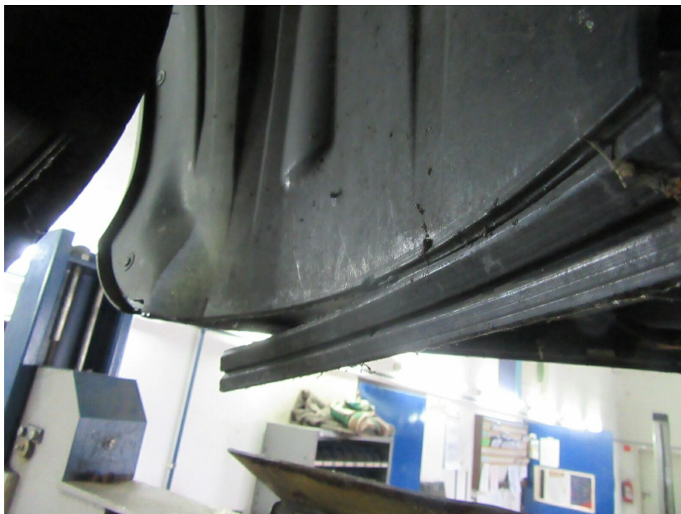
Bild 25 : Radhausschal vorn links gebrochen
