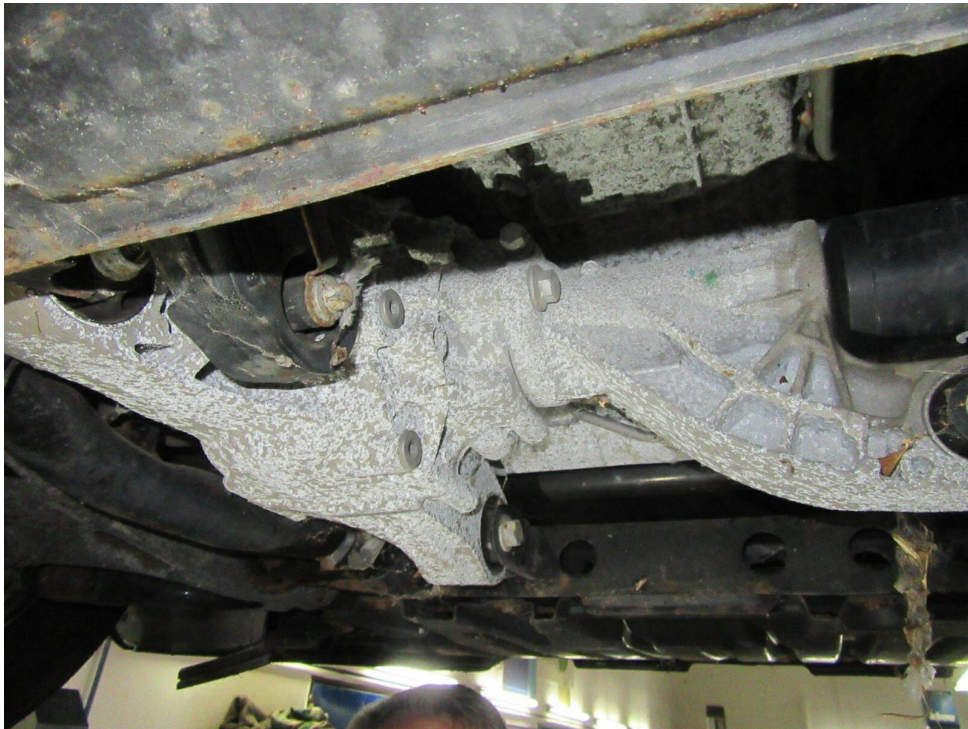
Bild 23 : Getriebe unterhalb stark korrodiert
