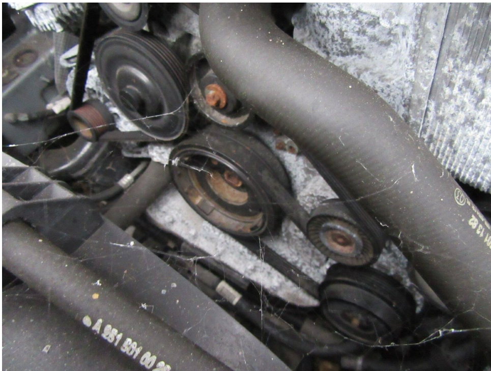
Bild 18 : Motor und Getriebegehäuse stark korrodiert- reinigen
