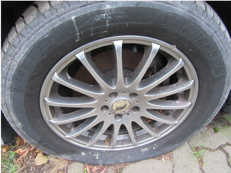
Bild 9 : Felge vorne links, korrodiert, lackieren mit Lackaufbau
