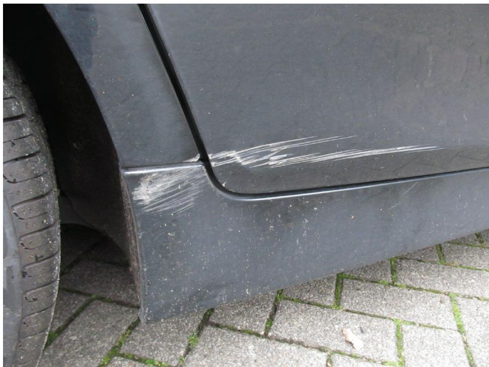
Bild 11 : Schwellerverkleidung, Tür und Radlauf hinten rechts verschrammt
