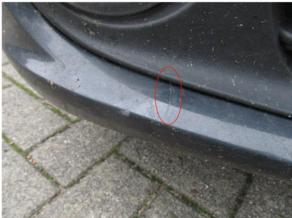
Bild 10 :      Stoßfängerabdeckung vorn leicht verkratzt
